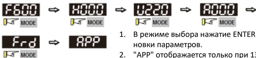
1. В режиме выбора нажатие ENTER приводит к переходу в режим установки параметров.
