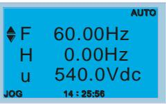
F 60.00 Hz >>> H >>> A >>> U (циклическое отображение).
