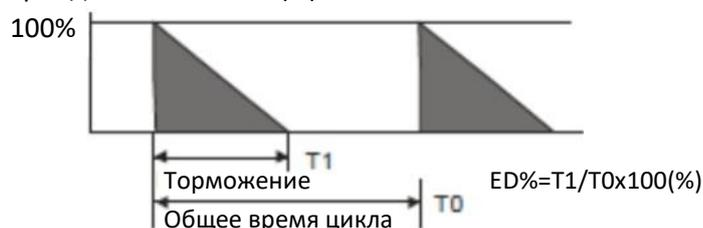
Комментарий: Расчётный ПВ (%) даёт достаточно времени тормозному модулю и тормозному резистору рассеять тепло, выделившееся в результате торможения. Рекомендованное время цикла T0 составляет 1 мин.
